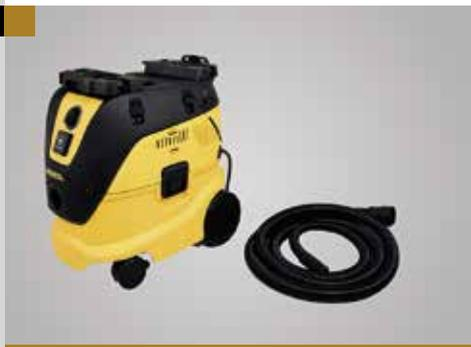
Die Industriesauger können bei Bedarf und gegen Aufpreis mit einem pneumatischem Start-/Stopp-System ausgerüstet werden. Dadurch schaltet sich der Industriesauger 1230 automatisch ein, wenn der angeschlossene Druckluft-Exzenter in Betrieb genommen wird.
