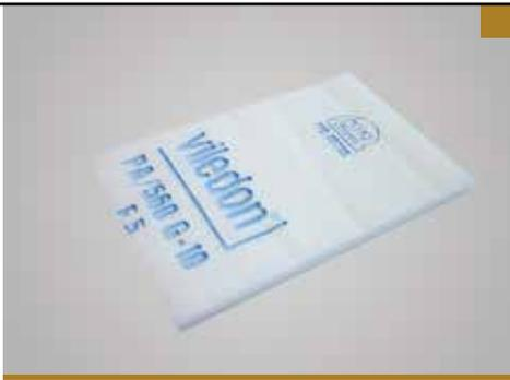
Hochleistungsfilter aus elastischen, bruchstärkeren Polyesterfasern. Der Filter ist progressiv aufgebaut, d.h. die Faserschichten mit unterschiedlichen Faserdurchmesser sind so hintereinander angeordnet, dass die Dichte zur Reinfluftseite hin zunimmt. Damit wird ein Optimum an definierter Filterleistung und Staubspeichervermögen erzielt. Das Ergebnis ist eine eindeutig längere Standzeit des Filters.
