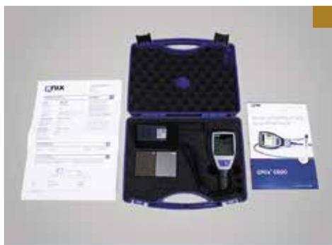
**QNIX® 5500 ELEKTRONISCHES SCHICHTSTÄRKENMESSGERÄT**
